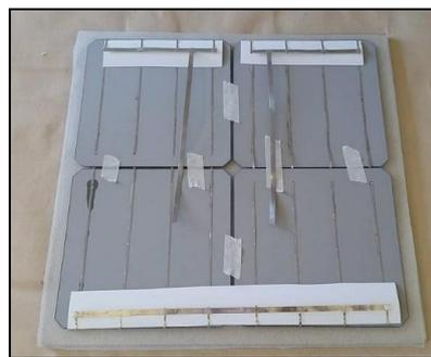
Figura 3 – Conexão em série das células fotovoltaica (fonte: do autor).
