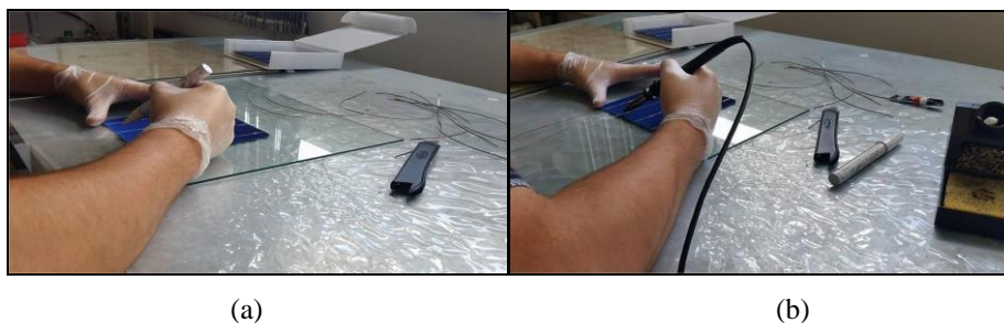
Figura 2 – Fluxo de solda nos terminais da célula (a) e integração da fita de estanho (1,8 mm) na célula fotovoltaica (b). (Fonte: do autor).
