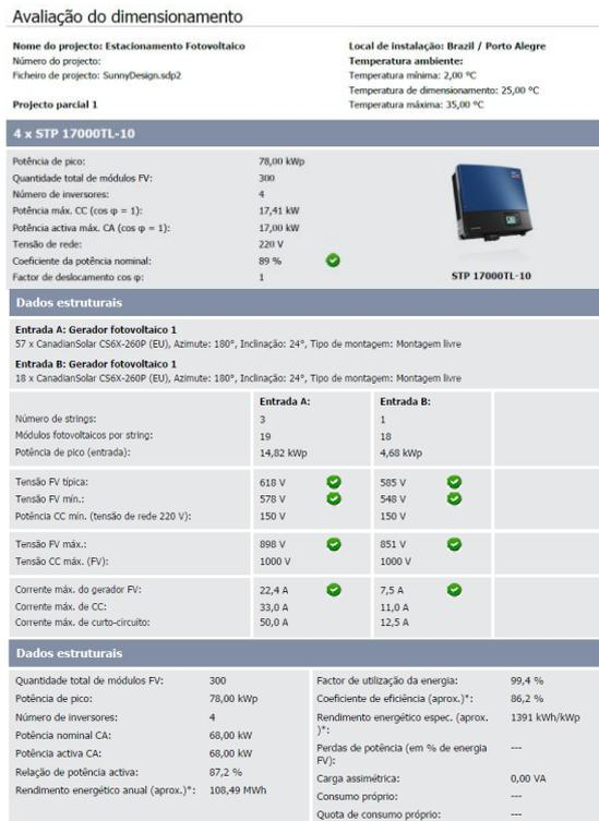
Figura 5 – Dimensionamento do Sistema Fotovoltaico
