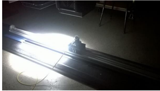
Figura 3- Pre-prototipo del sistema de medición de no uniformidad con movimiento en un eje realizando medidas de radiación continuas abajo de dos lámparas.
