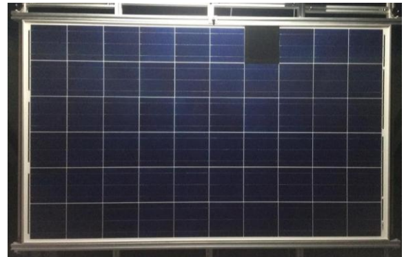
Figura 3 - Módulo fotovoltaico com célula 4 com bloqueio de irradiância.
