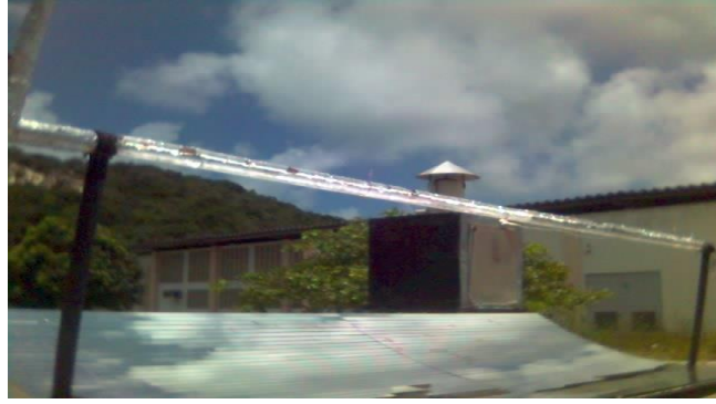
Figura 3. Tubo absorvedor do concentrador proposto
