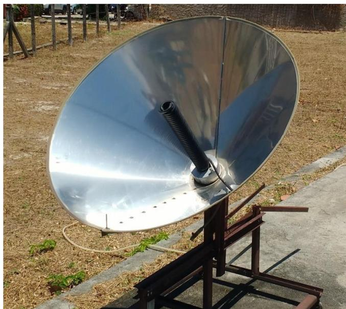
Figura 5 – Concentrador cônico instalado.
