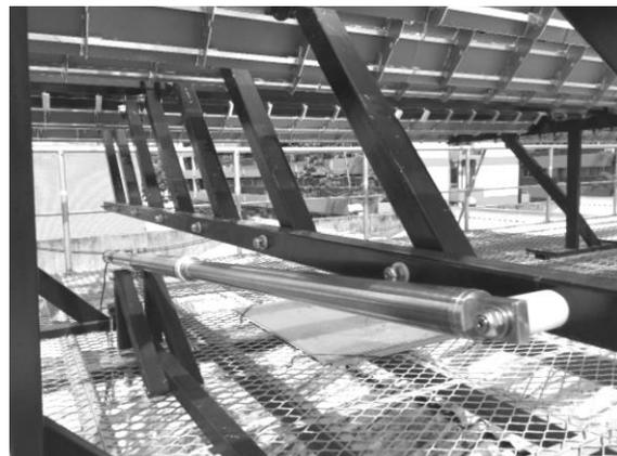
Figura 10 - Mecanismo de rastreamento solar
