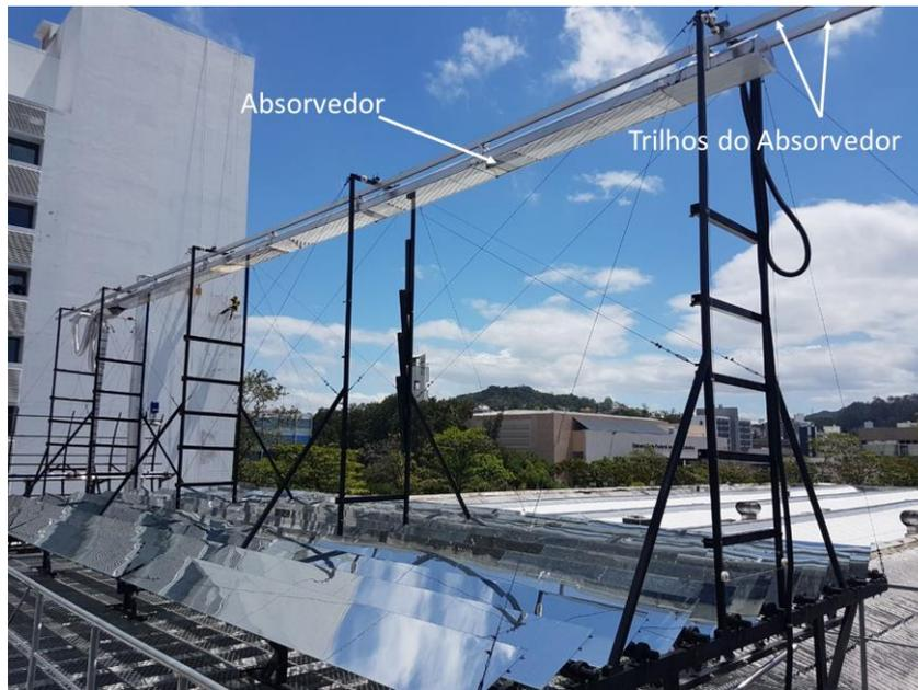
Figura 8 - Bancada experimental com absorvedor móvel
