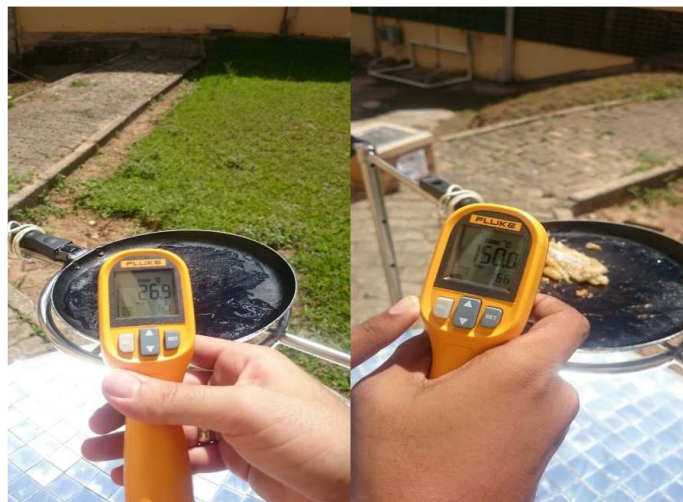
Figura 7. Frigideira, com frango, colocada no foco do concentrador solar e o multímetro fazendo a leitura da temperatura na panela.
