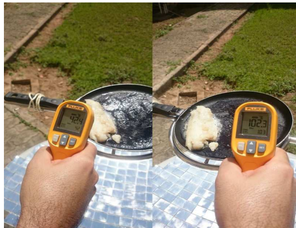
Figura 6. Frigideira, com peixe, colocada no foco do concentrador solar e o termômetro fazendo a leitura da temperatura na panela.
