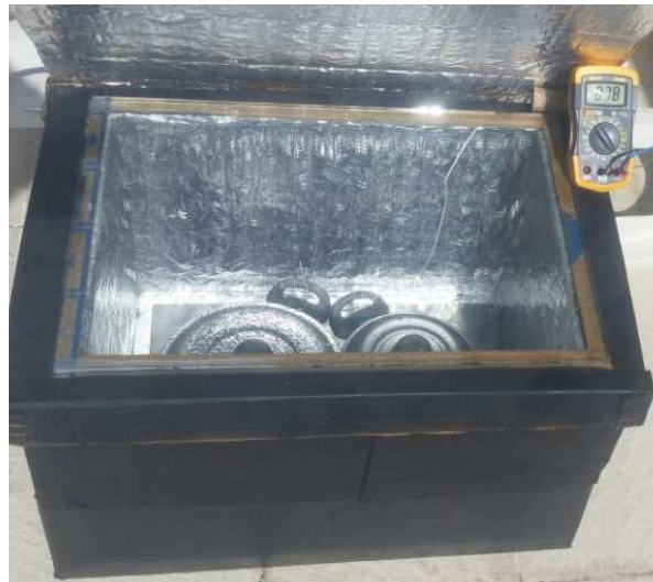
Figura 8: Fogão solar para cozimento de alimentos.
