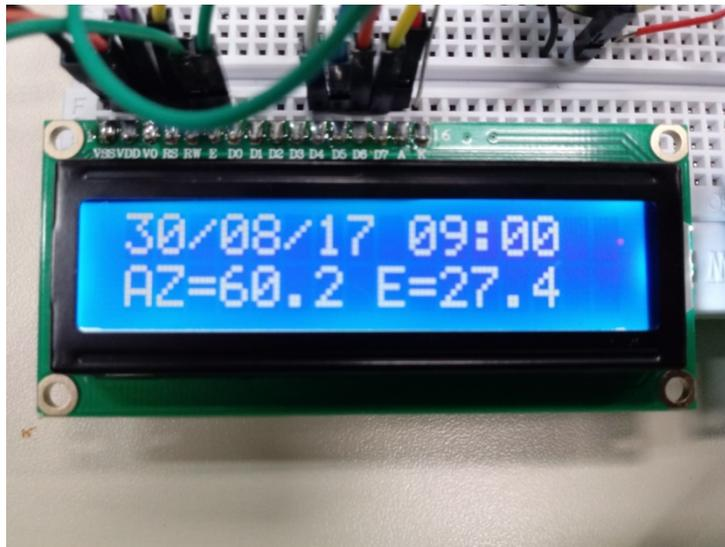
Figura 9 - Disposição dos dados em um display do tipo LCD (16x2) com as respectivas informações de data, hora, ângulos de azimute e ângulo de elevação solar.
