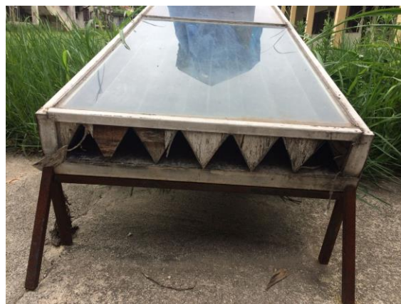
Figura 3 – Cantoneiras sanfonadas em triângulo do coletor solar.
