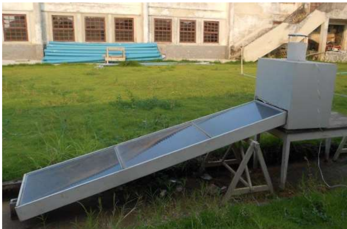
Figura 1 – Secador híbrido solar-elétrico
