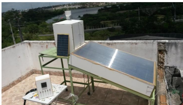
Figura 1- Sistema de secagem solar, capacitor térmico e os 10 termopares posicionados no sistema.
