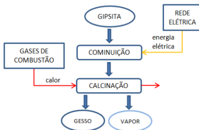
Figura 2 – Fluxograma de produção de gesso no PGA.
