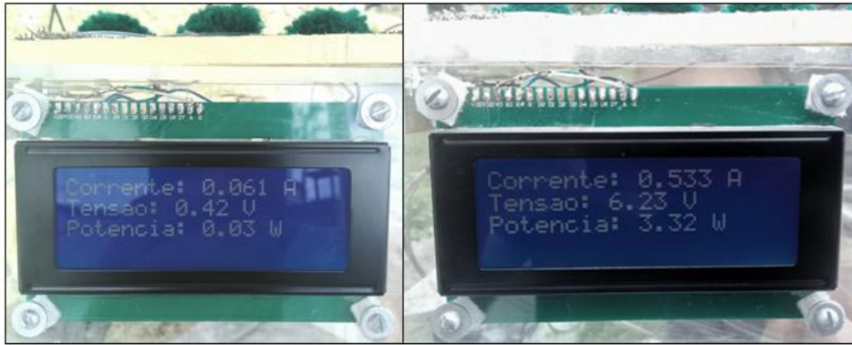
Figura 4- Mostrador LCD do kit didático de bombeamento fotovoltaico.
