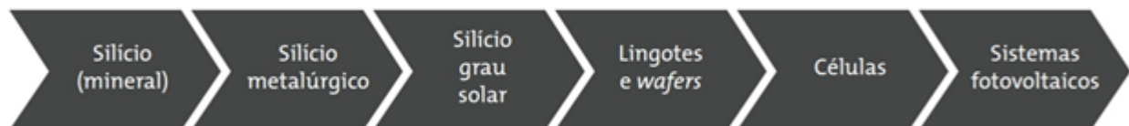
Figura 3 – Cadeia de processamento do silício para sistemas fotovoltaicos.
