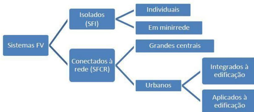
Figura 2 - Tipos de sistemas fotovoltaicos (Adaptado de Junior, 2010).
