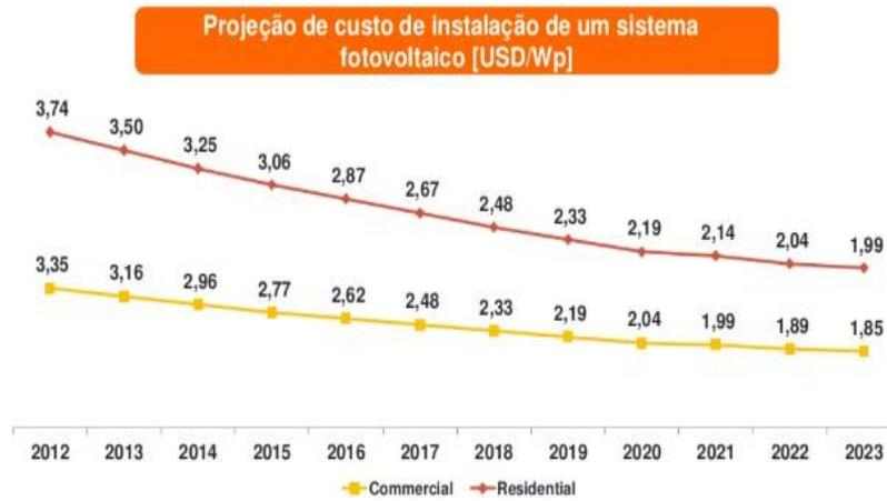
Figura 2 - Custo de instalação de sistemas fotovoltaicos (Ekon, 2016).
