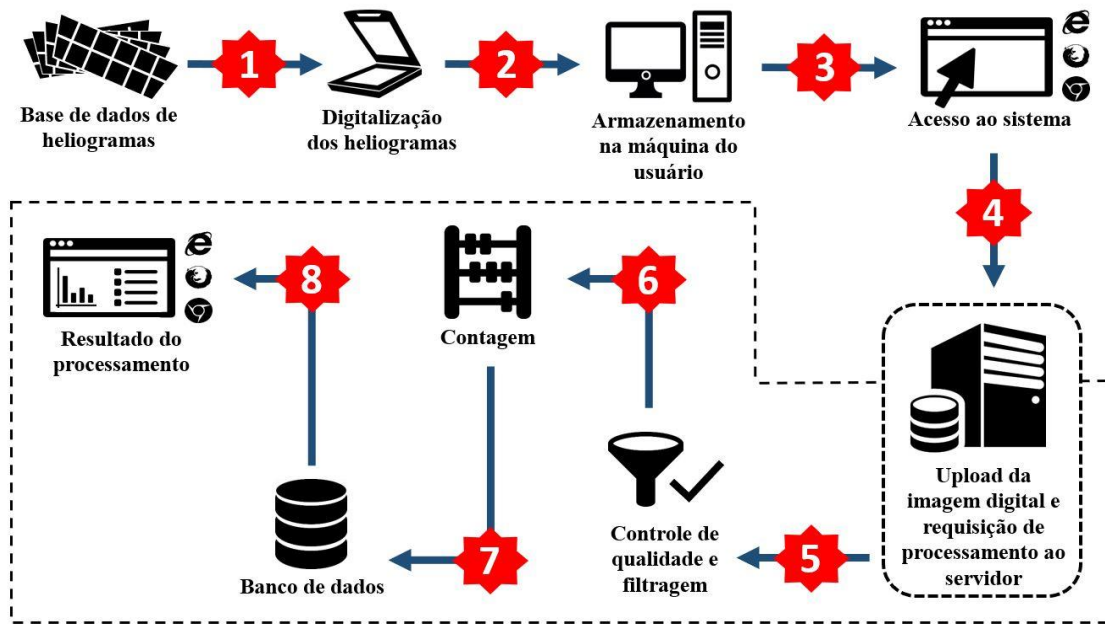
Figura 2 - Fluxo do processamento de dados de brilho solar.
