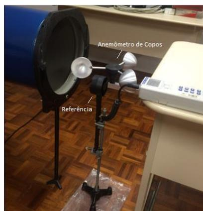
Figura 4 - Ensaio de calibração no túnel de vento.
