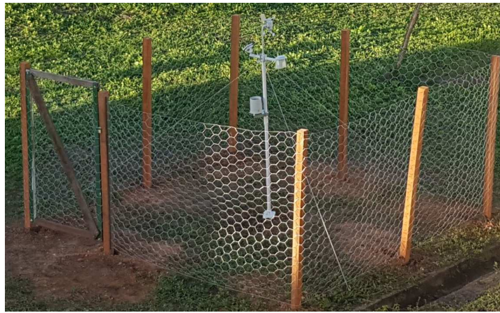
Figura 1- Estação Meteorológica Oregon Scientific - WMR200A instalada no IFS/Lagarto utilizada para validação/homologação dos dados fornecidos para estação projetada
