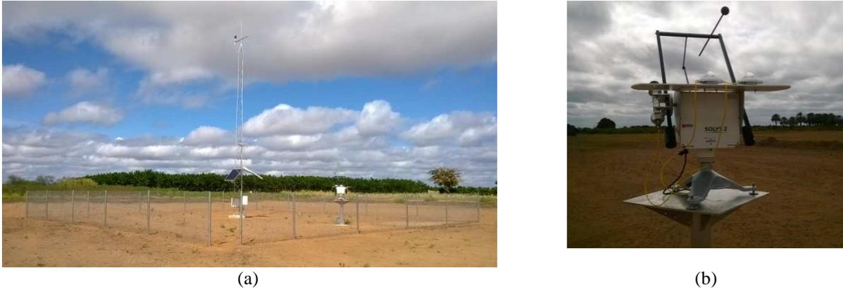
Figura 1 – Estação meteorológica (a) e detalhe dos instrumentos de medição das grandezas solarimétricas (b).
