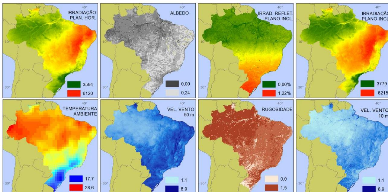
Figura 2: Grandezas ambientais e derivadas utilizadas para a elaboração do potencial de geração fotovoltaica
