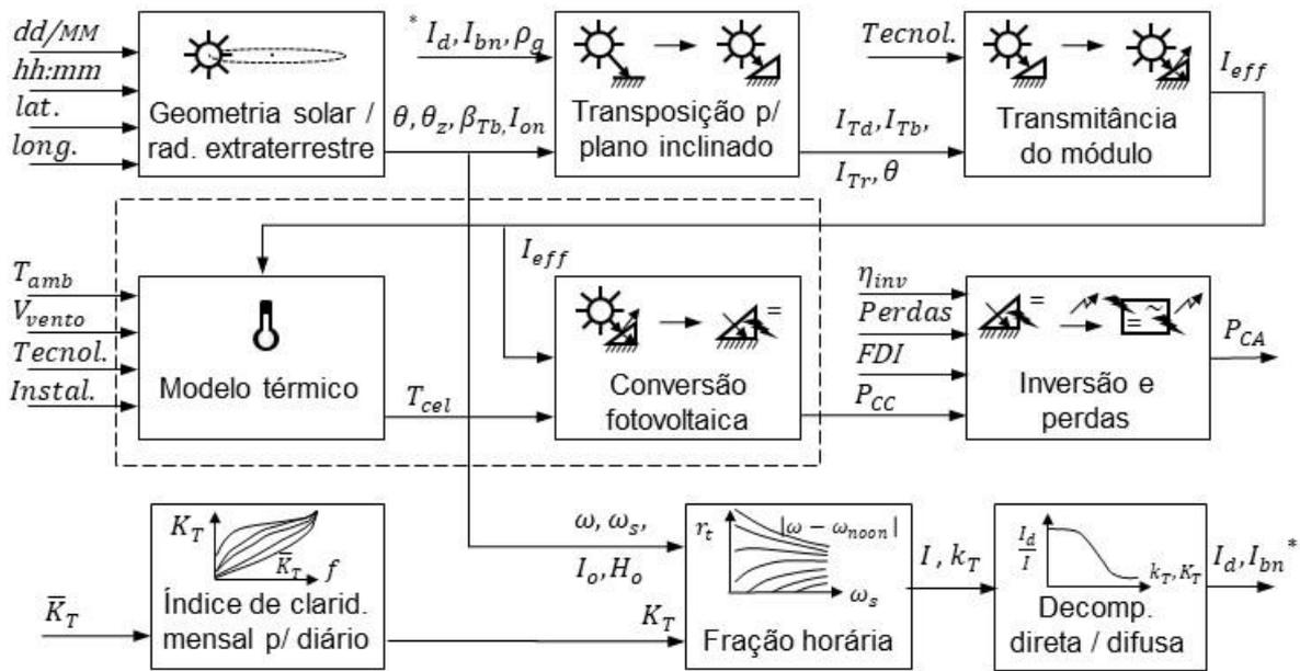
Figura 1: Diagrama ilustrativo dos algoritmos e técnicas empregados para conversão energética e síntese horária de radiação
