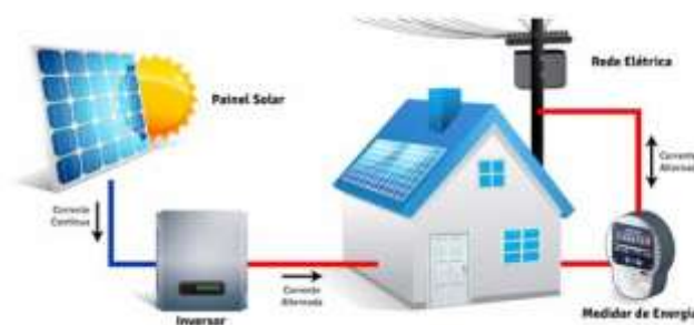
Figura 2 – Gerador fotovoltaico conectado à rede de distribuição.
