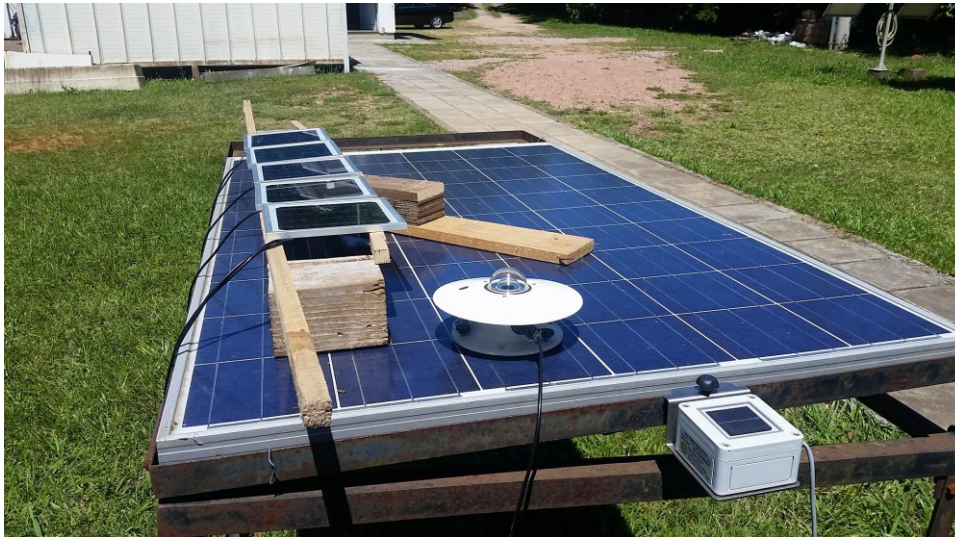
Figura 7 – Calibração outdoor das células de referência.
