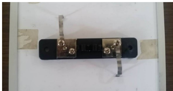
Figura 6 – Resistor shunt anexado na célula de referência.
