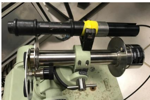
Figura 2 – Imagem do colimador de PVC acoplado a um sistema de mira e sonda do espectrorradiômetro para medição do espectro da radiação solar direta.
