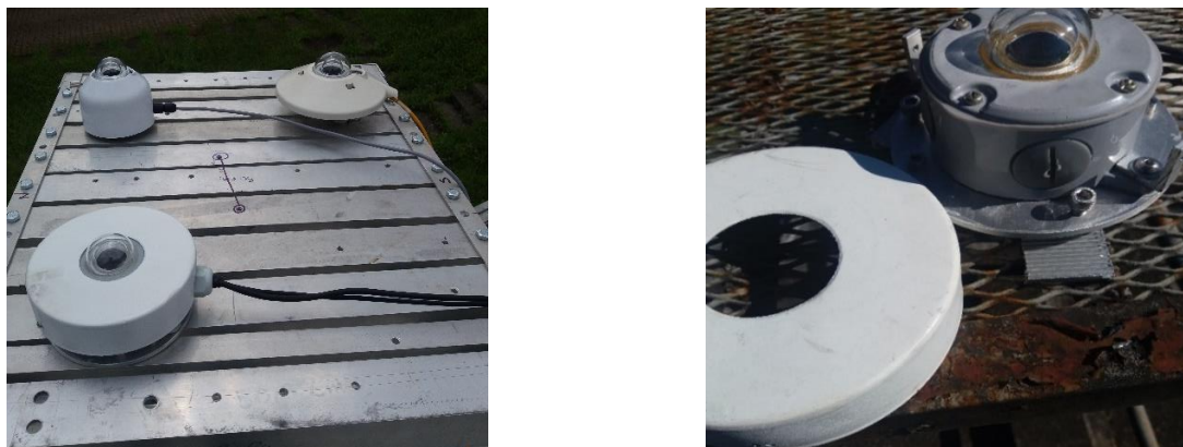
Figura 1 – Imagens do protótipo do piranômetro térmico. Na imagem à esquerda o protótipo está em primeiro plano. Os instrumentos no segundo plano são piranômetros comerciais utilizados para medições comparativas. Na imagem à direita há um detalhe do instrumento com o escudo desmontado.
