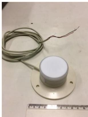
Figura 2 - Corpo do piranômetro proposto com difusor de acrílico.
