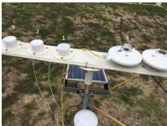
Figura 5 - Protótipos de piranômetros com os difusores em teste e o piranômetro de referência, KIPP&ZONEN CMP22. Nota: os protótipos estão enumerados de 1 a 3 e o piranômetro de referência com a enumeração 4.
