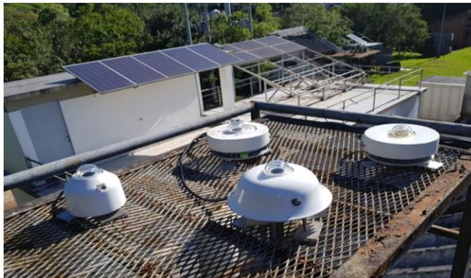
Figura 1 – Protótipos construídos ao lado do piranômetro de referência (à esquerda na foto).
