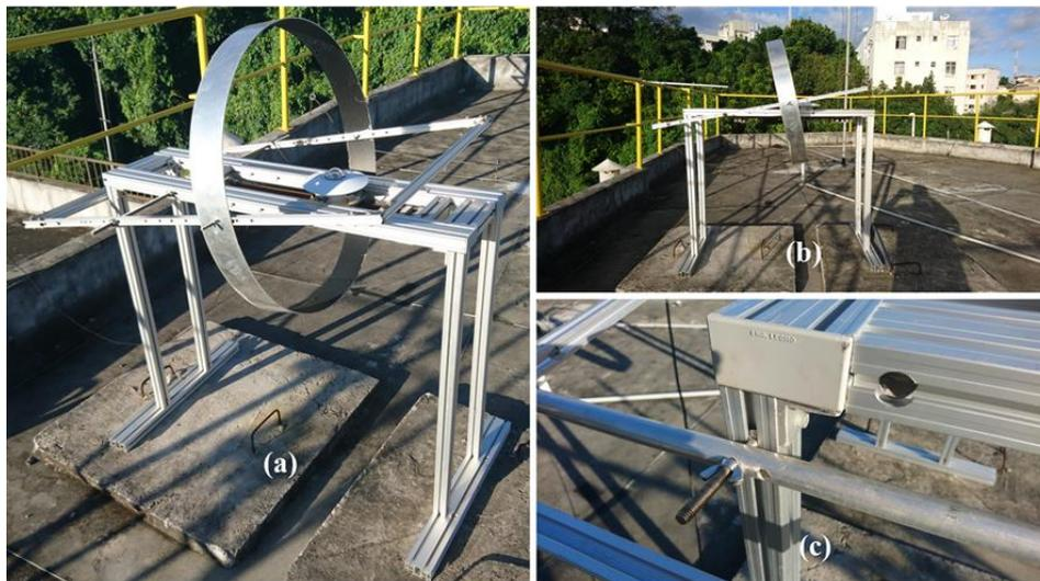
Figura 7 – DRMD instalado na PAMB-LabMiM. (a) visão geral da mesa montada; (b) visão lateral da mesa montada; (c) visão do mecanismo de ajuste de latitude  $\phi$ .
