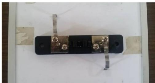
Figura 2 – Resistor shunt anexado na célula de referência (fonte: do autor).
