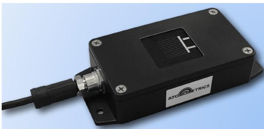
Figura 2 - Célula de referência. Fonte: Atonometrics
