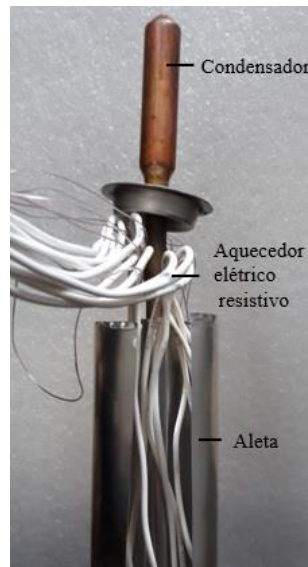
Figura 3 – Detalhe da resistência elétrica, da aleta metálica, e do condensador do heat pipe .
