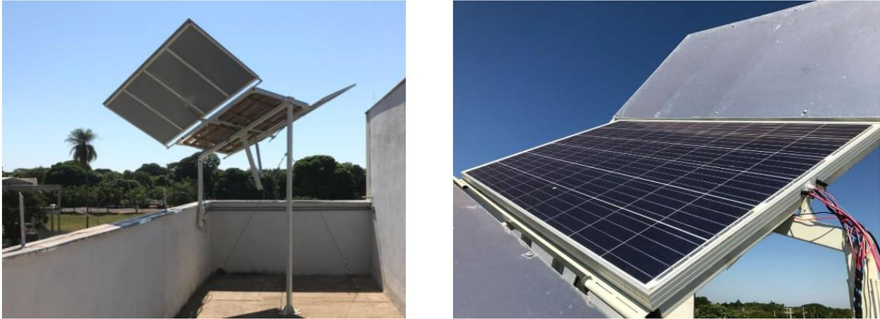
Figura 3. Aparato experimental com estrutura de rastreamento e concentração tipo V.
