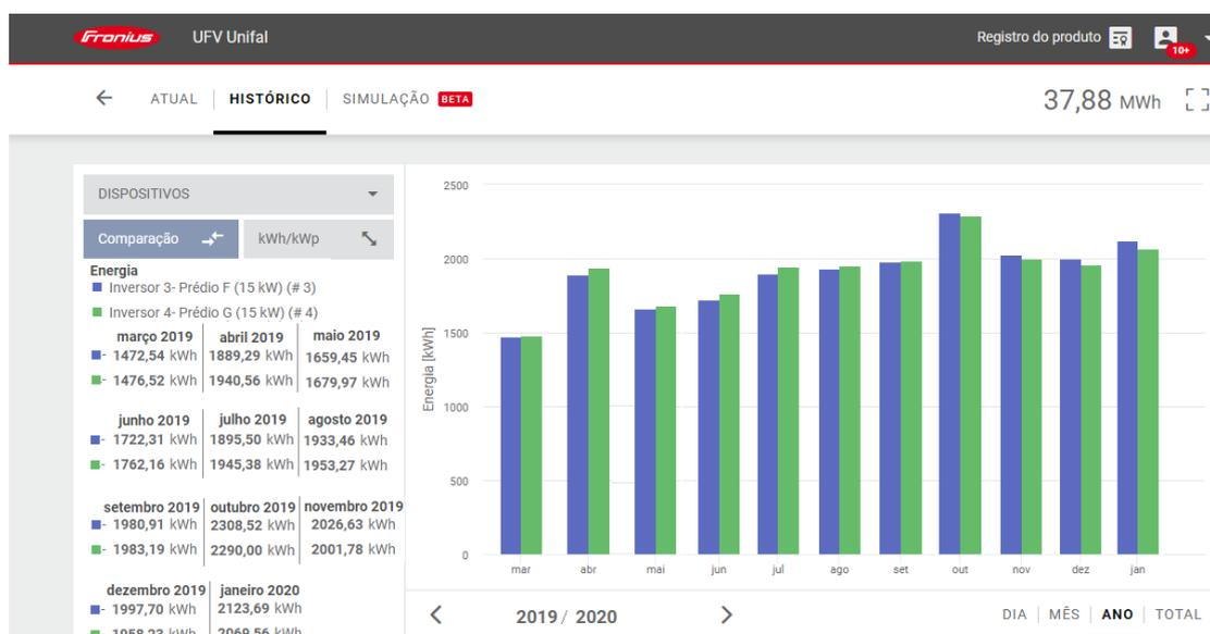
Figura 5 – Quantidade total de energia gerada nos Inversores 3 e 4 de março de 2019 a janeiro de 2020.
