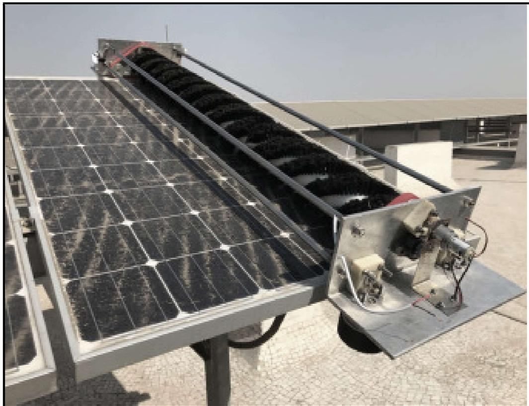
Figura 5 – Protótipo de limpeza sem utilização de água
