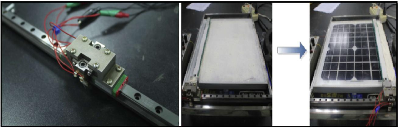
Figura 2 – Atuador linear baseado em piezoelétrico desenvolvido pelos autores, à direita módulo antes e após a limpeza realizada pela técnica.
