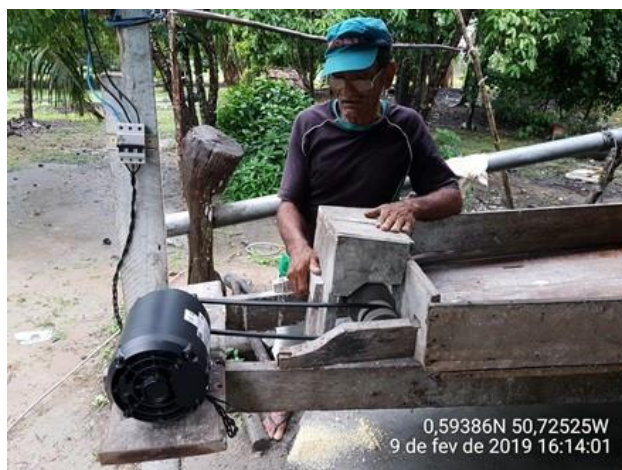
Figura 2 - Ralador de mandioca utilizado como carga motriz adicional.
