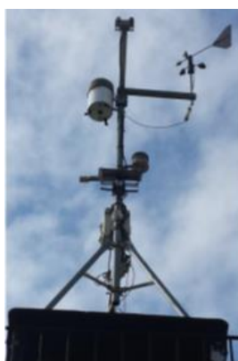
Figura 3 - Estação meteorológica da edificação.
