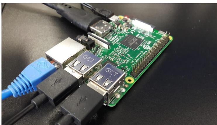
Figura 4 - Raspberry Pi 3 Modelo B como Registrador de Dados
