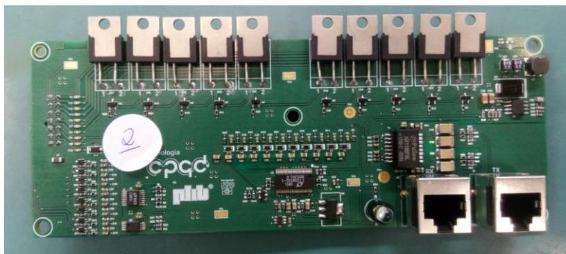
Figura 7 - Placa de circuito impresso (PCB) dos Módulos de Bateria (BMS)
