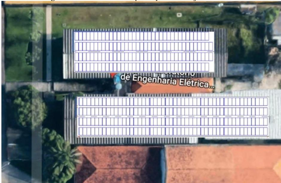
Figura 3: Disposição dos arranjos nas coberturas do LEEC
