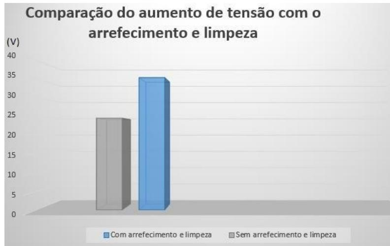
Figura 6 - Comparação do aumento de tensão com o arrefecimento e limpeza no módulo.
