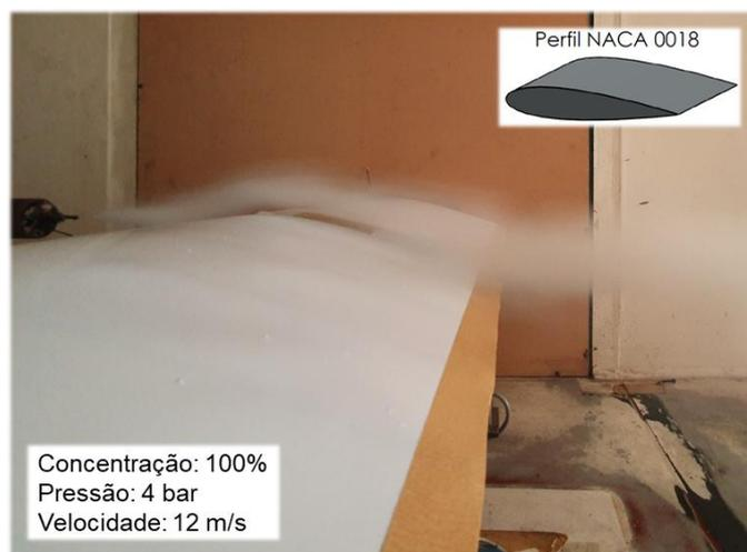
Figura 16 – Resultado da produção de fumaça injetada no fluxo de vento sobre um perfil aerodinâmico.
