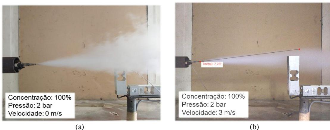
Figura 11 – Ensaio de performance do sistema de aquecimento e produção de fumaça e análise do ângulo de dispersão.
