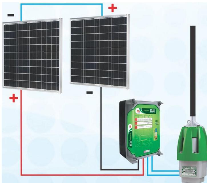
Figura 4– Componentes principais de um sistema de bombeamento fotovoltaico. Os módulos solares são de 85 Wp e tensão de 17 volts cada, ligados em série. Fonte: Anauger Solar, 2011.
